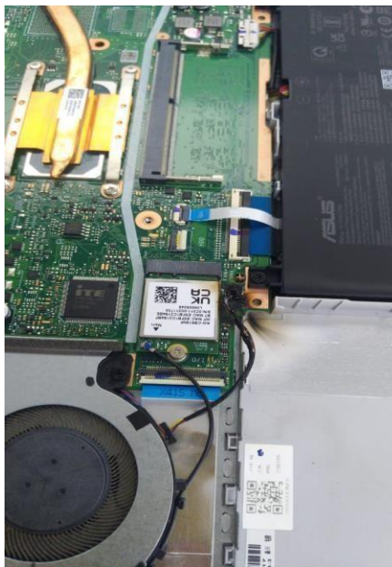
Gambar 2. Mengetahui kerusakan unit setelah di bongkar (terbakar)
